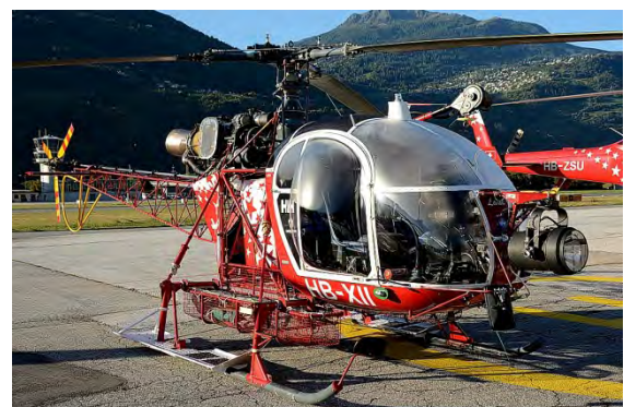
Der SA 315 B Lama HB-XII der Air Zermatt mit dem angebauten und lichtstarken Scheinwerfer Nightsun SX-16
