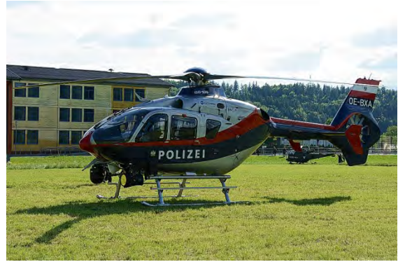
Der EC 135 P-2i OE-BXA der Flugpolizei war mit FLIR (ForwardLookingInfraRed) Kamera und zusätzlichem Suchscheinwerfer vom Typ SX 16 ausgestattet
